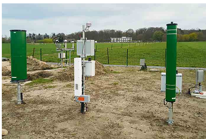
Diese neu installierten „Cosmic-Ray-Neutron-Sensor“-Messsysteme bestimmen die mittlere Bodenfeuchte im Umkreis von mehreren Hektar.
