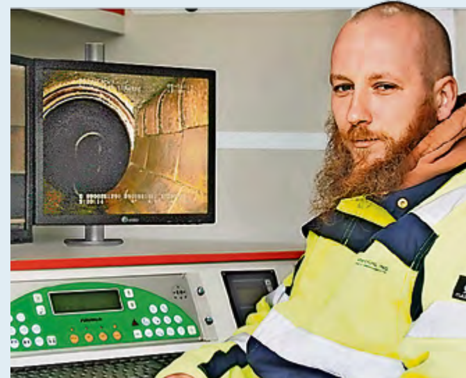
Am Monitor im Fahrzeug verfolgt Robert Seidel den Weg der Kamera im Untergrund und erfasst die Schäden genau.
