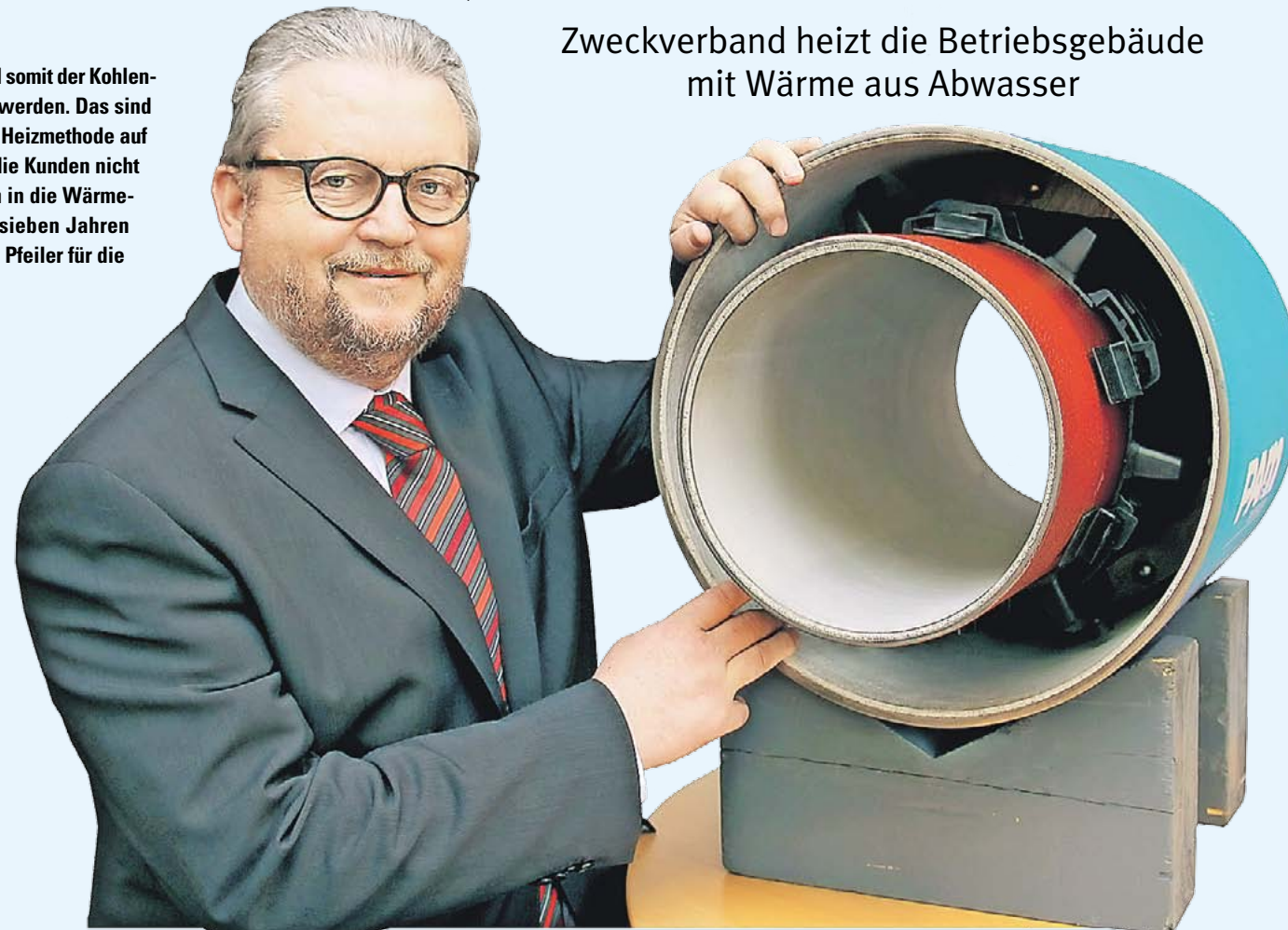
Klaus Rhode, Geschäftsführer des Zweckverbands KÜHLUNG, zeigt ein Modell des Wärmetauschers. Zwischen dem innenliegenden Abwasser- und dem äußeren Mantelrohr erfolgt der Wärmeaustausch.
